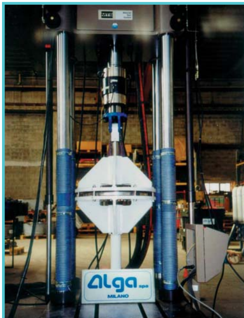
Fig. 4 - 5 Prove dinamiche con la macchina MTS Dynamic test with MTS machine
