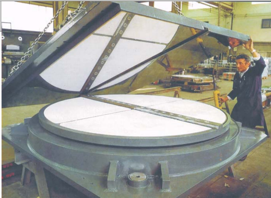
La lavorazione dei componenti per appoggi Algapot viene effettuata utilizzando le più moderne attrezzature. Manufacturing details of steel components of Algapot bearings, using the most updated machining equipment.
